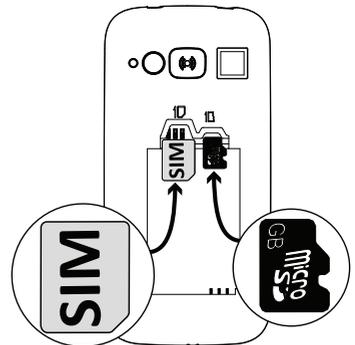
Suchen Sie die Halterung für die SD-Karte und folgen Sie den Anweisungen für die SIM-Karte. Das Gerät kann mit oder ohne installierter SD-Karte verwendet werden.
